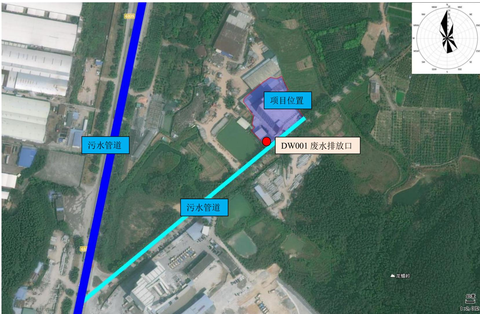
附图 12 鹤山市桃源镇污水处理站污水管网图
