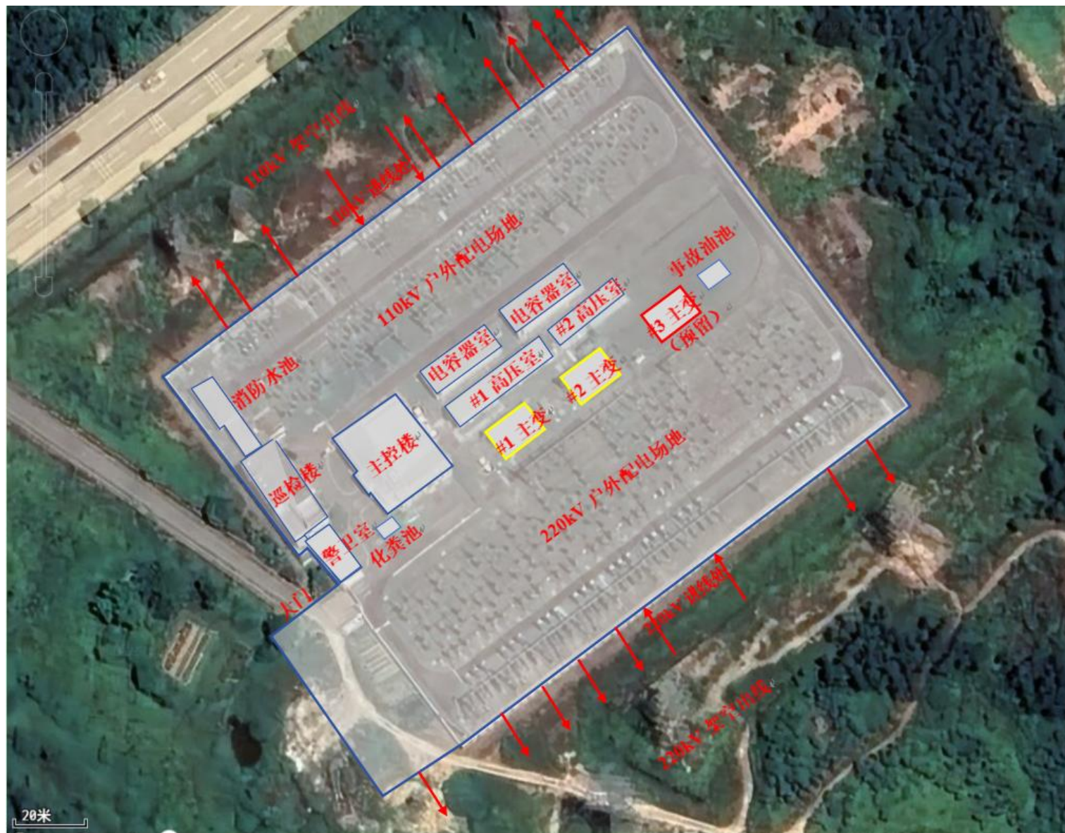
附图 7 江门 220kV 彩虹变电站站内现状布置示意图
